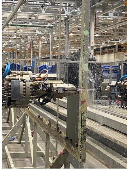
Resim 2.3:Robotik sistemle çalışan UT.
