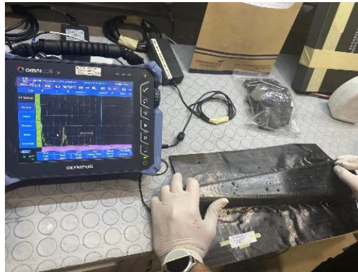
Resim 2.4:Taşınabilir cihazla yapılan UT.
