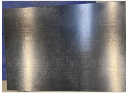
Resim 3.1:Şekil verme işlemine uğramamış laminat plaka.
