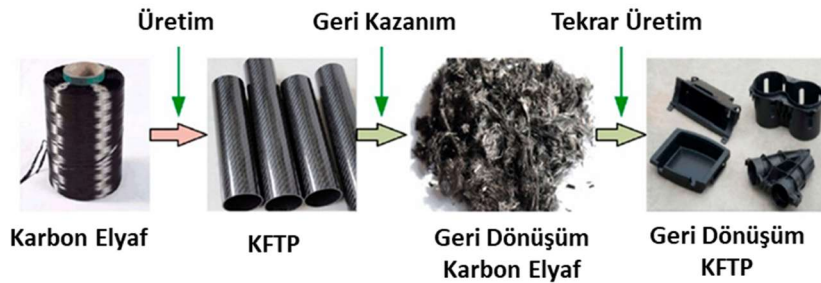
Şekil 2.5: Mekanik geri dönüşüm ile geri kazanılmış elyaf [19]
