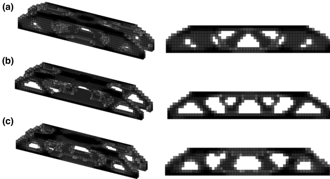
Fig. 9 Optimum MBB beam designs: a CTO, b STO (design used in SePPTO), c SiPPTO
